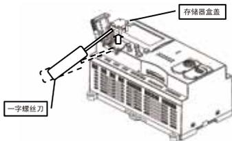
拆下存储器盒盖后，请注意方向，将存储器盒上的“▽”标记与 SmartAXIS 的“△”标记对齐，以安装存储器盒。
