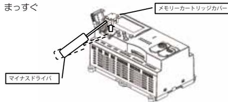
メモリーカートリッジカバーを取り外した後、メモリーカートリッジの▽マークと、SmartAXISの△マークが合うように、方向に注意してメモリーカートリッジを取り付けてください。
