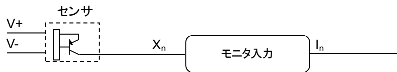
図 5.13 モニタ入力ファンクション回路
